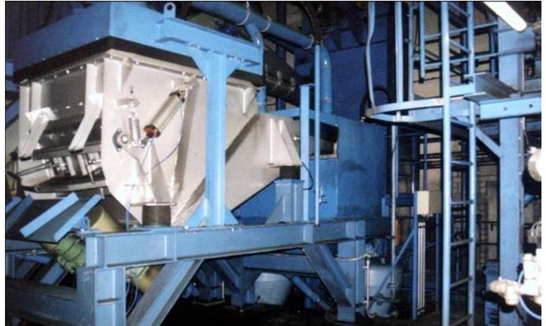
Abbildung: Knollenbrecher mit Grobteilaustrag, rechts im Bild das Gerüst für Sichter/Kühler-Einheit
