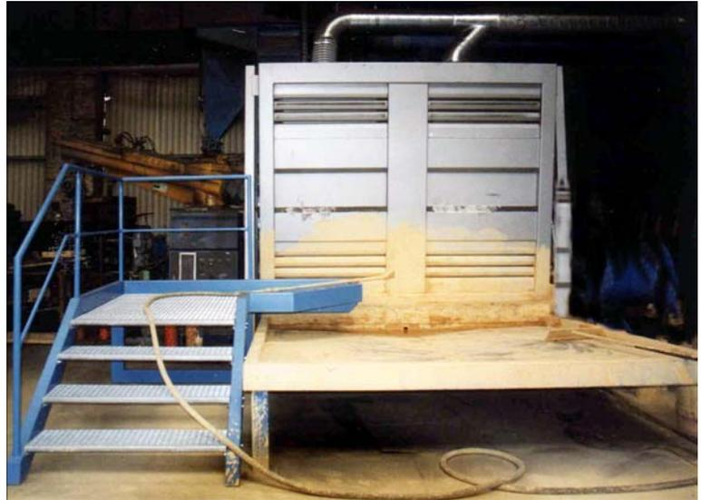
Abbildung: Flutbecken mit Absaugwand
